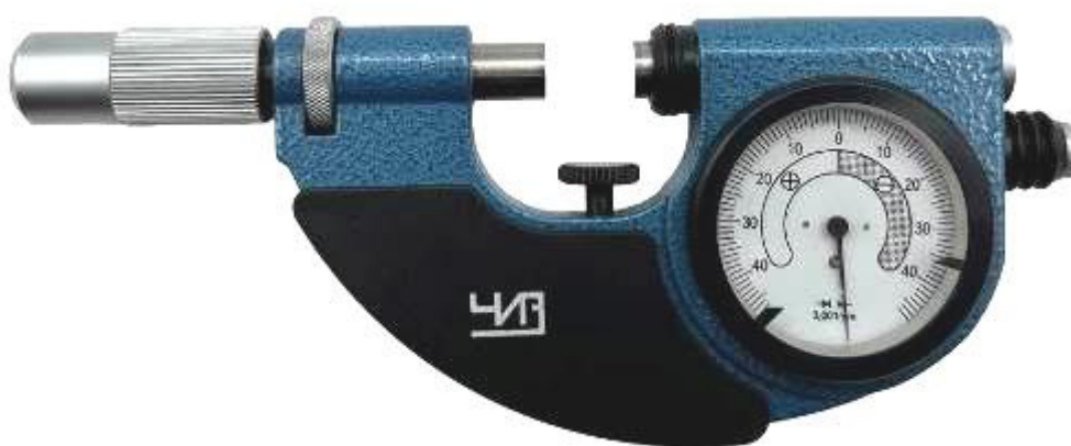
Рисунок 5 – Общий вид скоб модели СРП
