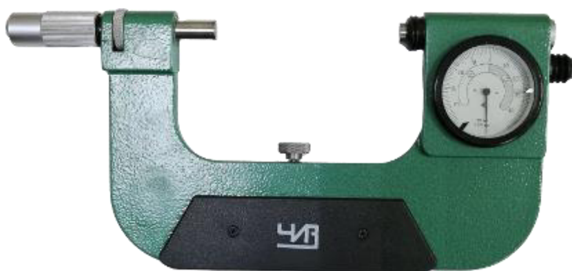
Рисунок 8 – Общий вид скоб модели СРП
