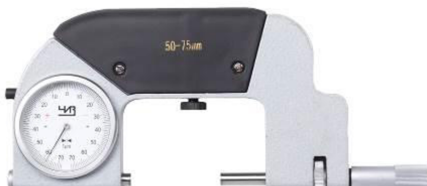
Рисунок 4 – Общий вид скоб модели СРП
