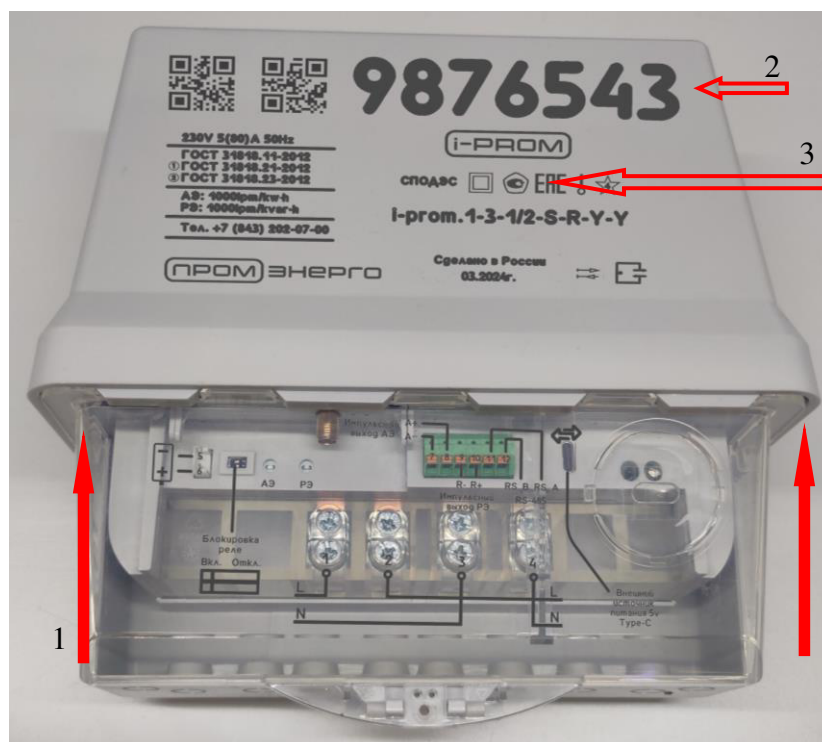
Рисунок 4 – Схема пломбировки от несанкционированного доступа (1), место нанесения заводских номеров (2) и место нанесения знака утверждения типа (3) на счетчике i-prom.1 в корпусе S – Split
