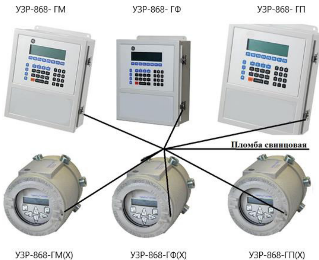
Рисунок 3 – Схема пломбирования расходомеров УЗР-868-ГМ(Х), ГФ(Х), ГП(Х)
