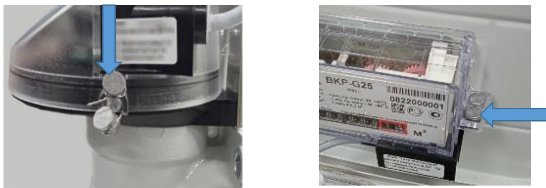
Рисунок 5 – Схема пломбировки от несанкционированного доступа места присоединения датчика импульсов, обозначение места нанесения знака поверки счетчика газа
