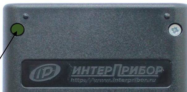
Рисунок 3 – Место нанесения пломбировки от несанкционированного доступа на панели электронного блока
