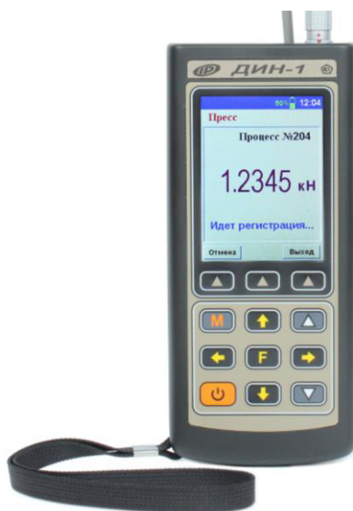
Рисунок 1 – Общий вид электронного блока динамометра
