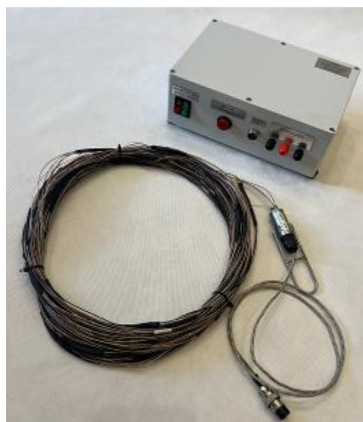
Рисунок 4 –ЦТПТ и пульт для проверки термоподвесок
