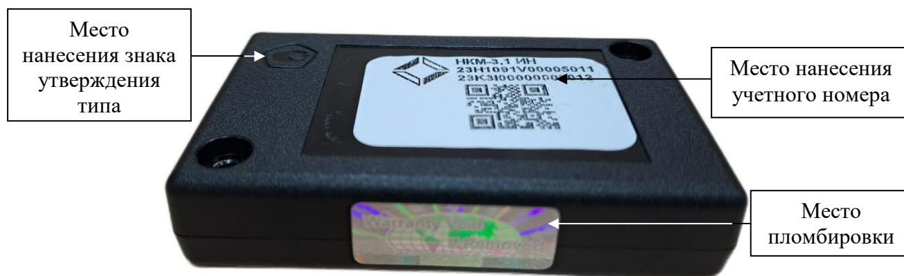
Рисунок 1 – Общий вид блоков, обозначение мест нанесения знака утверждение типа, учетного номера, схема пломбировки от несанкционированного доступа
