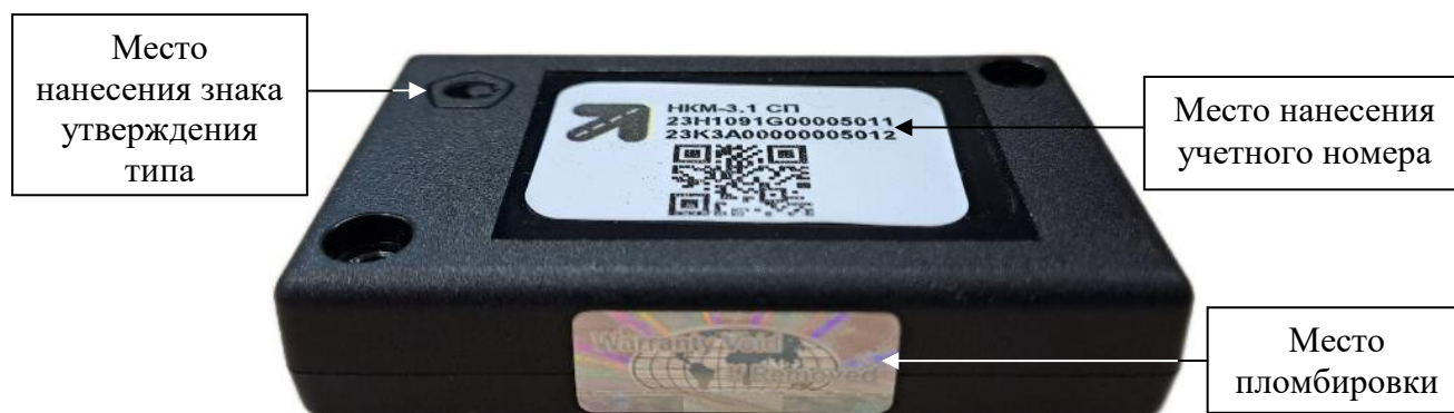
Рисунок 1 – Общий вид блоков, обозначение мест нанесения знака утверждение типа, учетного номера, схема пломбировки от несанкционированного доступа
