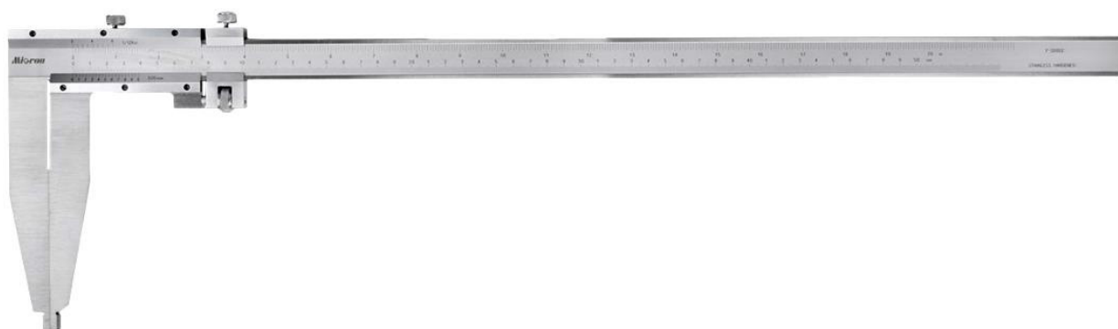
Рисунок 8 – Общий вид штангенциркулей модификации ШЦ-III со шкалой в миллиметрах, рамкой, соединённой винтами, дополнительной шкалой на штанге в дюймах и увеличенным вылетом губок
