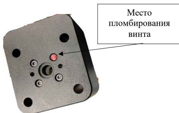
Рисунок 8 – Общий вид измерителей крутящего момента силы Helixa-i
