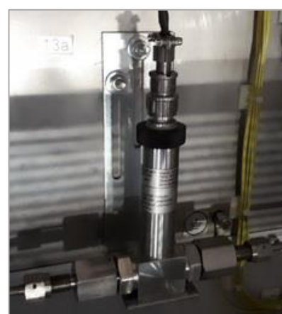
Рисунок 8 – Преобразователь перепада давления первичный АИР-10Н-ДД. Вид внешний
