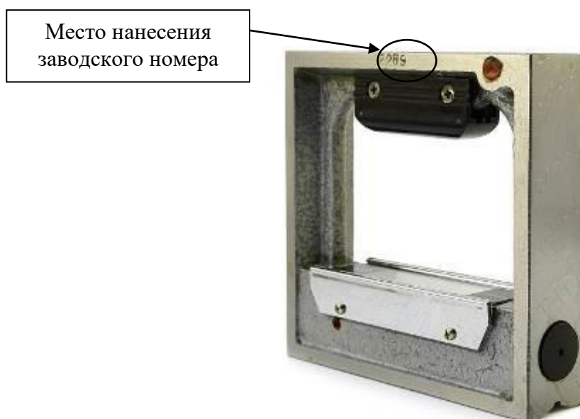
Рисунок 5 – Общий вид уровней модели брусковый с указанием места нанесения заводского номера
