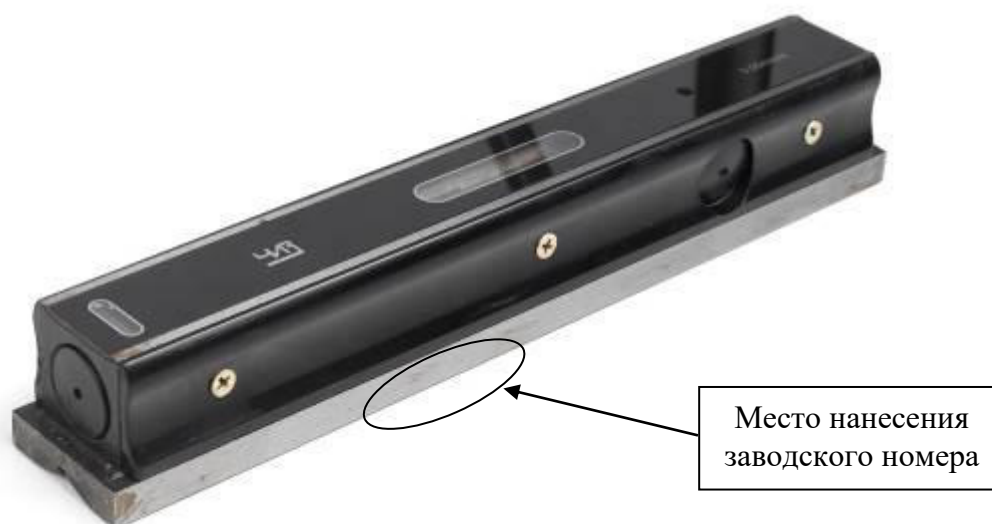
Рисунок 4 – Общий вид уровней модели брусковый с указанием места нанесения заводского номера
