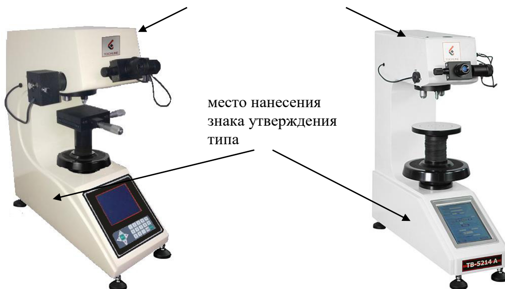
Рисунок 1 – Общий вид твердомеров TB 5214-5 Tochline, TB 5214-10 Tochline, TB 5214-30 Tochline, TB 5214-50 Tochline, TB 5214-100 Tochline
