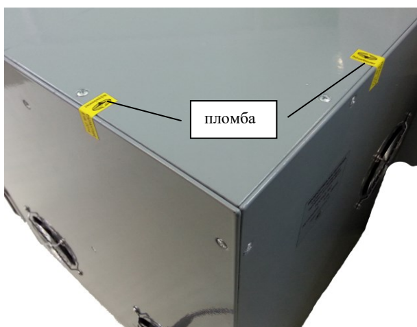
Рисунок 2 – Схема пломбировки анализаторов
