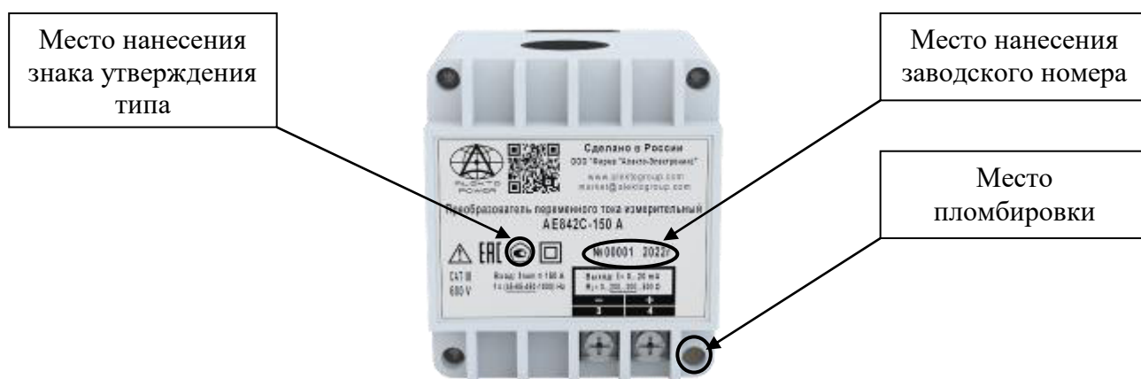
Рисунок 2 – Общий вид преобразователей AE842C с номинальным током свыше 5 A и указанием места пломбировки, мест нанесения заводского номера и знака утверждения типа
