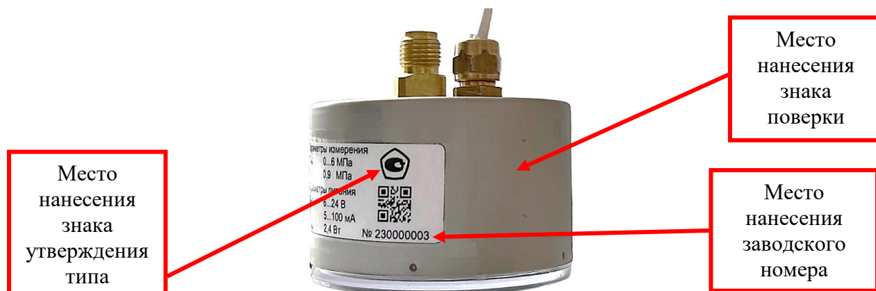
Рисунок 2 – Места нанесения знака поверки на корпус манометра, знака утверждения типа и заводского номера на технической табличке манометра ДМ2015Сг, ДМ5010Сг0Ех, ДМ5012Сг
