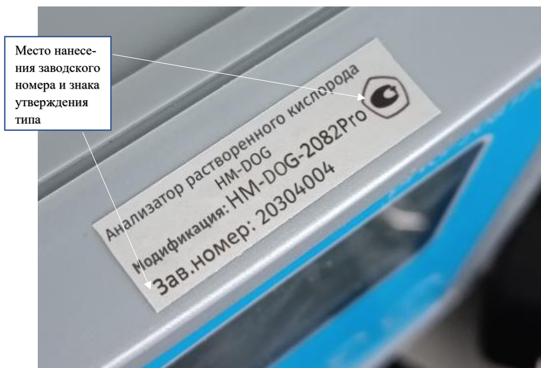
Рисунок 1в – Общий вид верхней поверхности вторичного преобразователя (микропроцессорного блока) с указанием места нанесения заводского номера и знака утверждения типа
