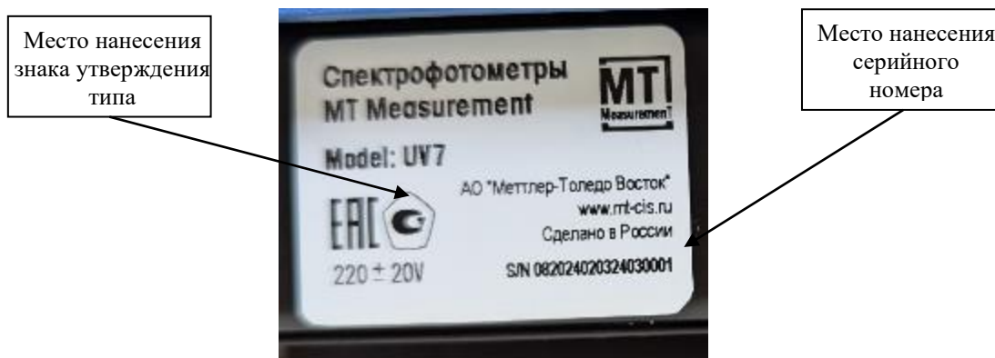
Рисунок 2 – Место нанесения серийного номера и знака утверждения типа на спектрофотометры MT Measurement
