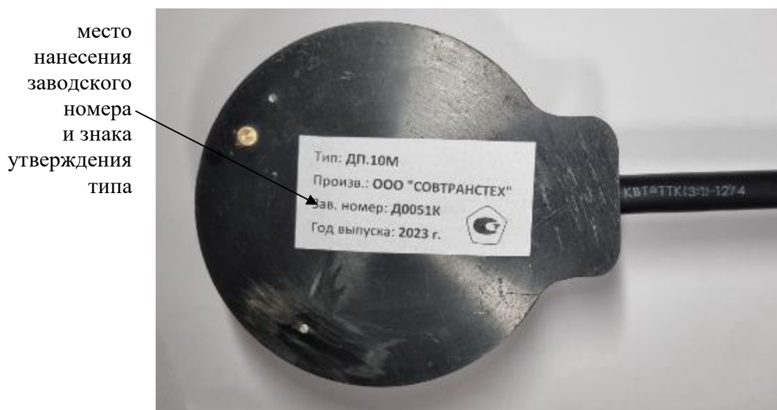
Рисунок 2 – Общий вид датчиков ДП.10 с указанием места нанесения заводского номера и знака утверждения типа
