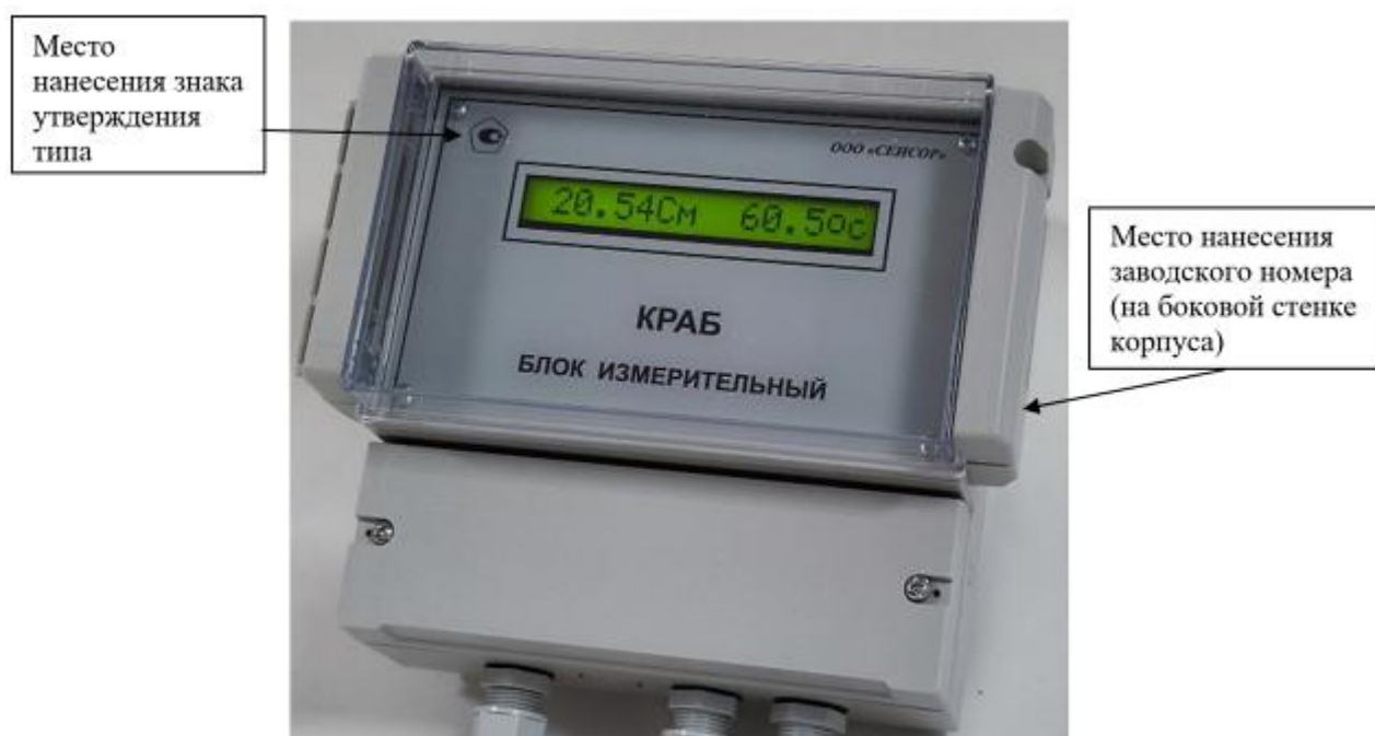
Рисунок 1 – Общий вид измерительного блока кондуктометров настенного исполнения с указанием места нанесения знака утверждения типа и заводского номера
