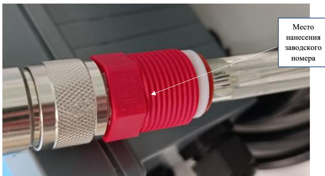
Рисунок 1г – Общий вид электрода рН/т с указанием места нанесения заводского номера
