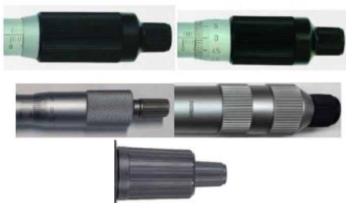
Рисунок 7 – Варианты исполнений барабана микрометрического винта микрометров
