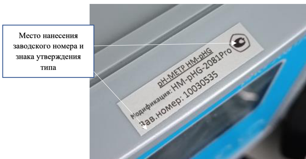
Рисунок 1в – Общий вид верхней поверхности вторичного преобразователя (микропроцессорного блока) с указанием места нанесения заводского номера и знака утверждения типа
