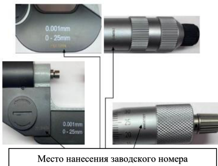
Рисунок 8 – Место нанесения заводского номера на микрометры
