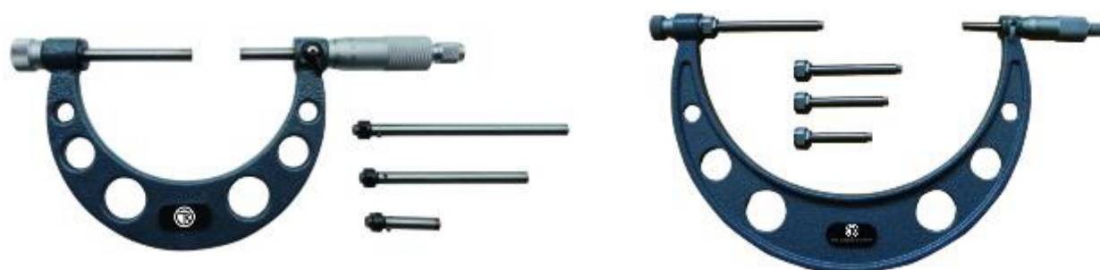
Рисунок 3 – Общий вид микрометров моделей МК со сменными пятками
