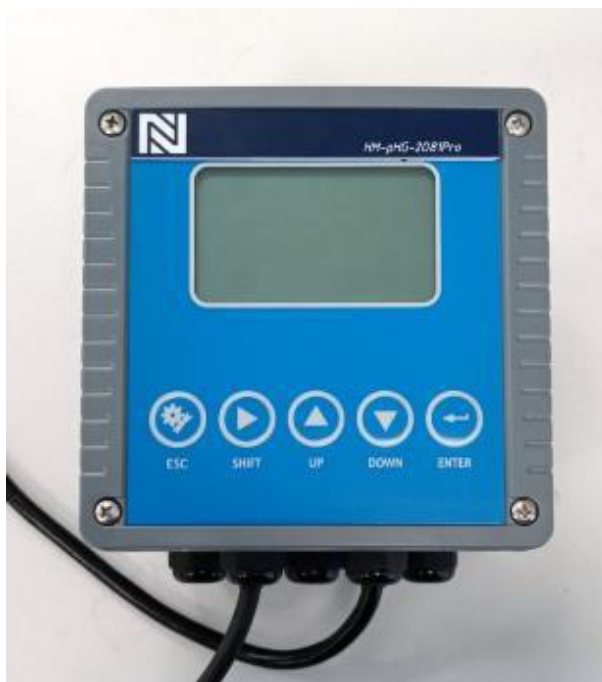
Рисунок 1а – Общий вид вторичного преобразователя (микропроцессорного блока) рН-метра
