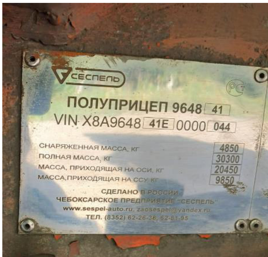
Рисунок 3 – Общий вид маркировочной таблички ППЦ
