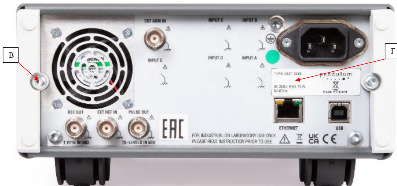
Рисунок 3 – Вид задней панели частотомеров, место пломбировки от несанкционированного доступа (В) и место нанесения серийного номера (Г)
