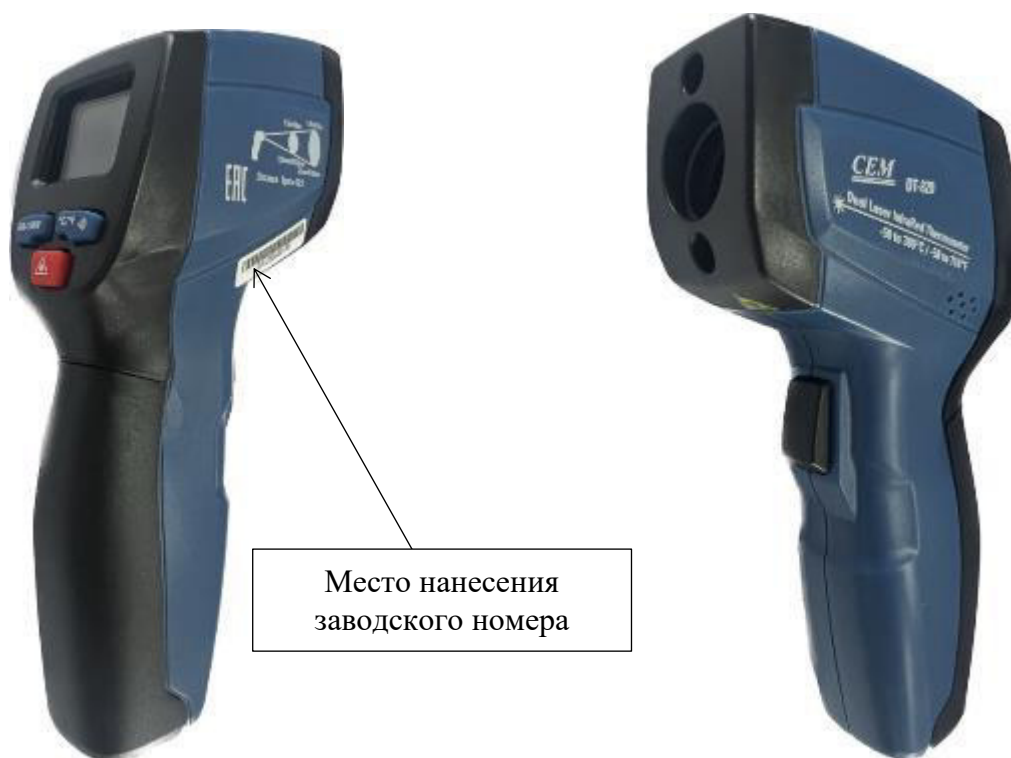
Рисунок 1 – Общий вид пирометров инфракрасных СЕМ модели DT-820
