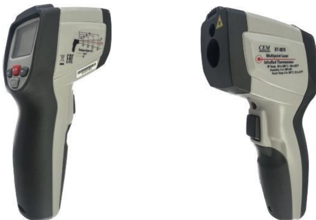
Рисунок 4 – Общий вид пирометров инфракрасных CEM модели DT-8870
