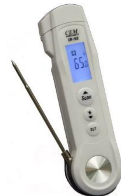
Рисунок 6 – Общий вид пирометров инфракрасных CEM модели IR-95
