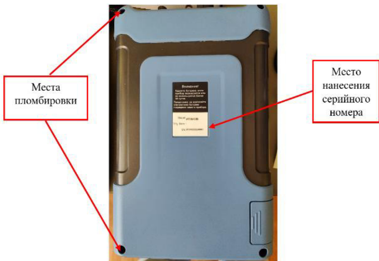
Рисунок 2 – Схема пломбировки и место нанесения серийного номера
