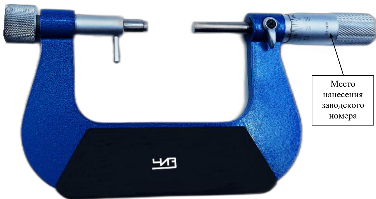
Рисунок 5 – Общий вид микрометров модификации МРИ и МРИ Ц без установленного (съёмного) отсчетного устройства
