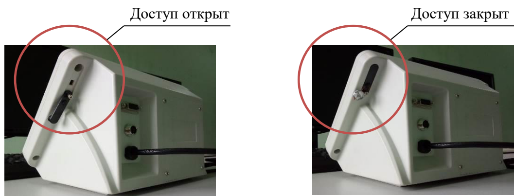
Рисунок 3 - Схема пломбировки приборов КСК от несанкционированного доступа
