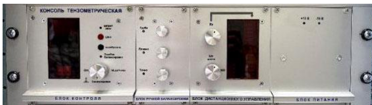
Рисунок 2 – Общий вид консоли тензометрической
