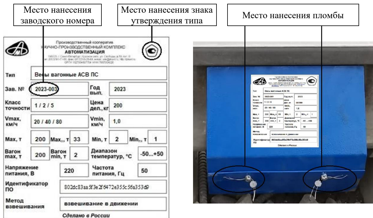
Рисунок 3 – Маркировочная табличка и АЦПД с пломбировкой
