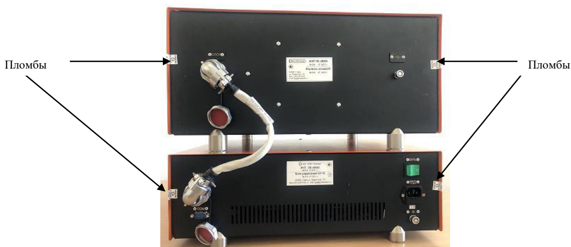
Рисунок 2 - Схема пломбирования излучателя от несанкционированного доступа
