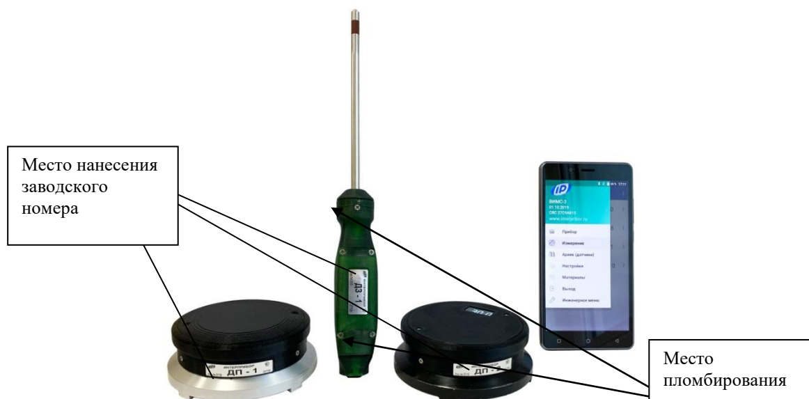
Рисунок 1 - Общий вид измерителя влажности ВИМС-3, места пломбировки от несанкционированного доступа и место нанесения заводского номера
