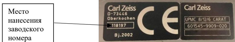
Рисунок 2 – Общий вид маркировочной таблички машины координатно-измерительной UPMC850 CARAT
