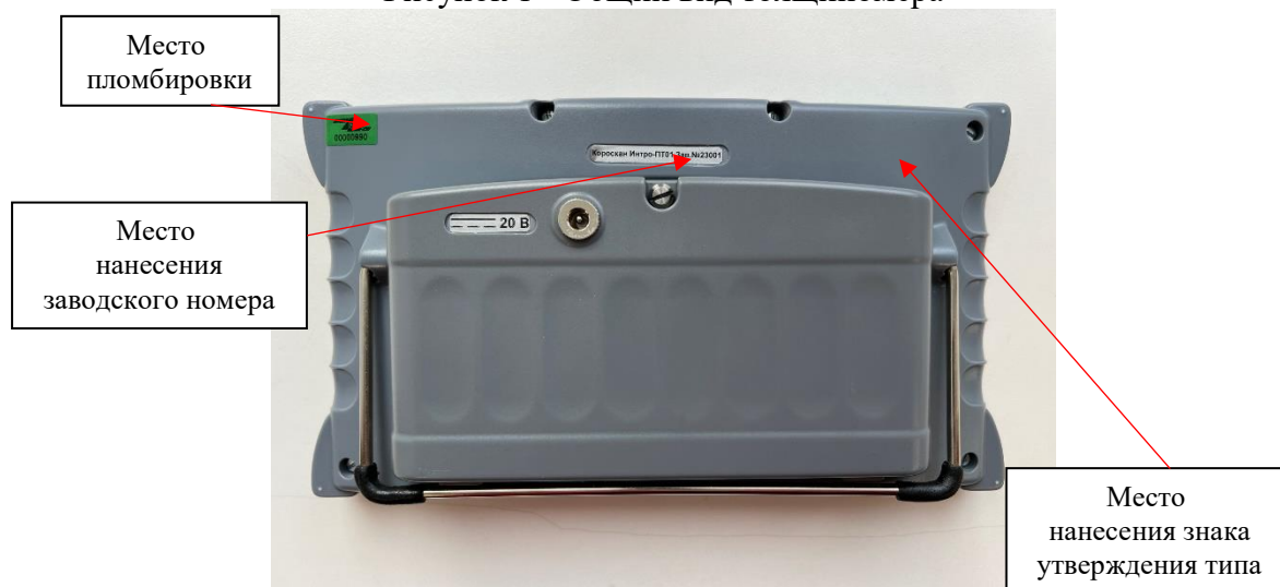
Рисунок 2 – Схема пломбировки от несанкционированного доступа и места нанесения заводского номера и знака утверждения типа
