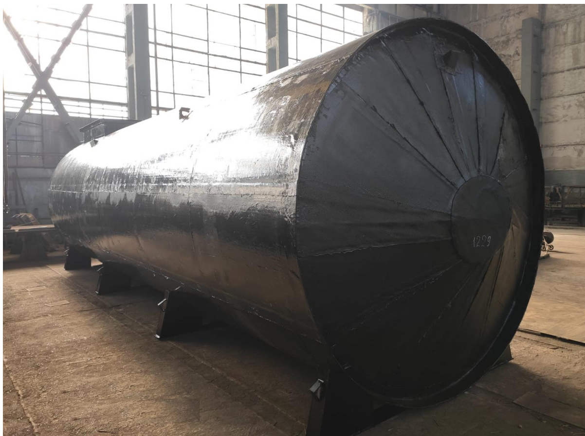
Рисунок 2 – Общий вид резервуара РГСДп-50
