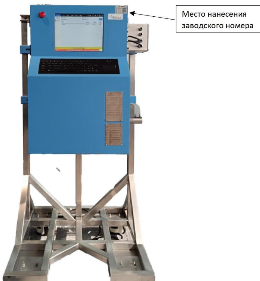
Рисунок 1 – Общий вид и место нанесения заводского номера хроматографа газового PGC-3000 EDITION II
