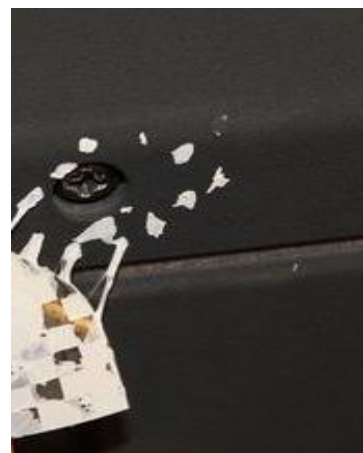
Рисунок 3 – Вид защитной наклейки на винте крепления корпуса компьютера при попытке ее снятия
