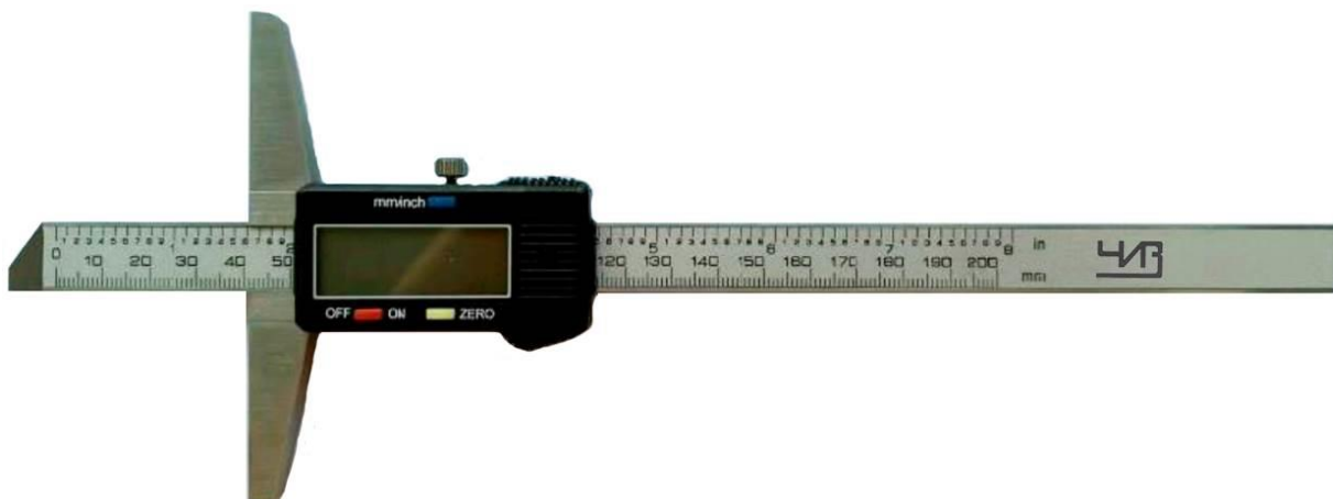
Рисунок 6 – Общий вид штангенглубиномеров модификации ШГЦ со скошенным торцом штанги
