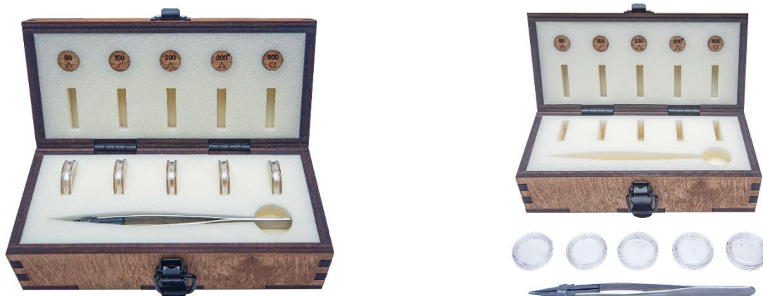
Рисунок 6 – Общий вид наборов микрограммовых гирь
