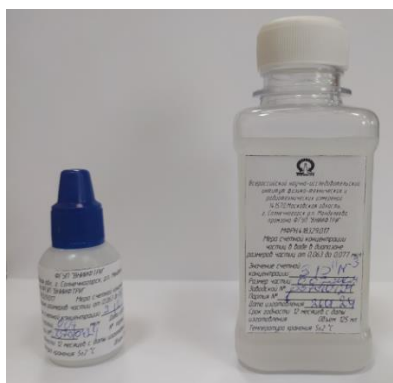
Рисунок 1 – Общий вид мер счетной концентрации частиц в воде МСК-В-0,07
