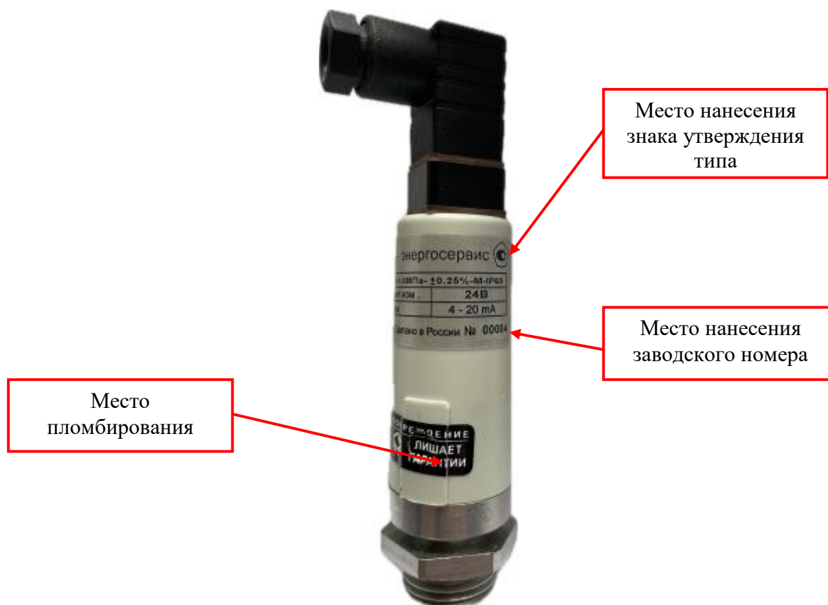
Рисунок 1 – Общий вид датчиков давления ИД-5 с местом нанесения заводского номера, знака утверждения типа и местом пломбирования
