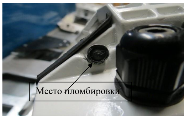
Рисунок 3 – Схема пломбировки видео модуля
