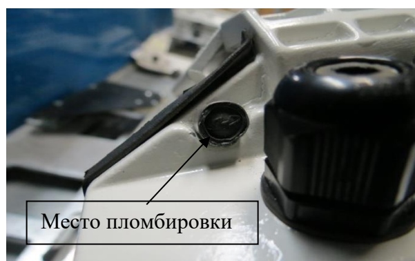
Рисунок 4 – Схема пломбировки видео модуля
