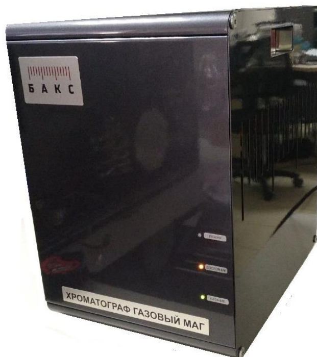
Рисунок 5 – Общий вид хроматографов газовых промышленных МАГ модели КС 50.310-000-01 в невзрывозащищенном (лабораторном) исполнении (исполнение 2) с панелью светодиодов
