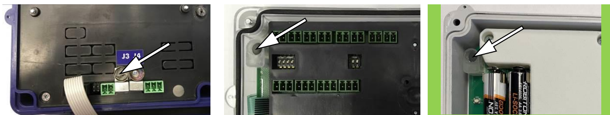
Рисунок 2 – Места пломбировки от несанкционированного доступа тепловычислителей ВЗЛЕТ TCPB
