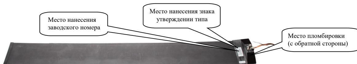
Рисунок 1 – Общий вид составных частей, входящих в состав набора для калибровки испытательных генераторов наносекундных импульсных помех ЭМС-НКНИП, обозначение мест нанесения знака утверждения типа, заводского номера и схемы пломбировки от несанкционированного доступа
