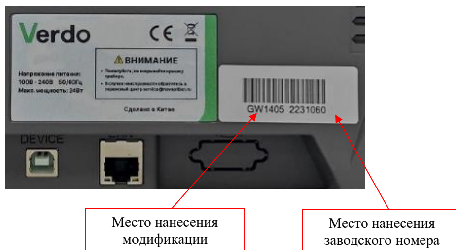
Рисунок 4 – Фрагмент задней панели генераторов с этикеткой
