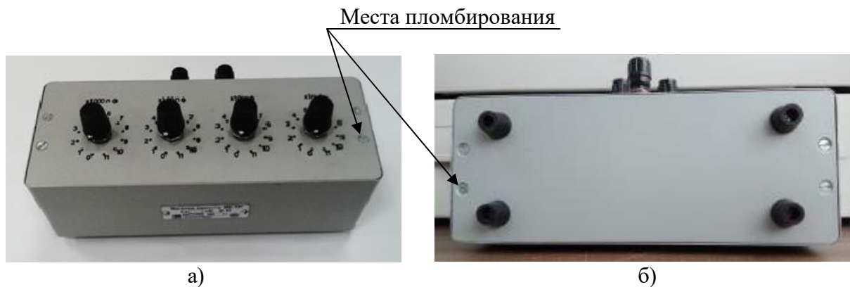
Рисунок 2 – Места пломбирования от несанкционированного доступа
