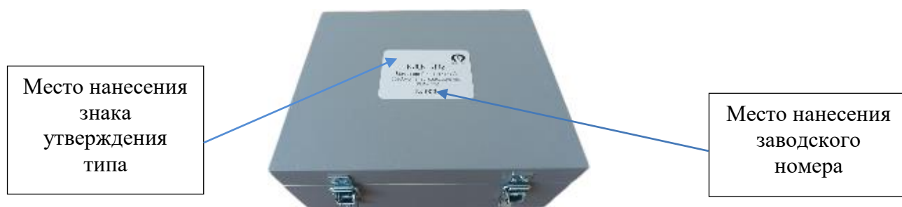
Рисунок 1 – Внешний вид КИСК-7М2 (в футляре) с обозначением мест нанесения знака утверждения типа и заводского номера
