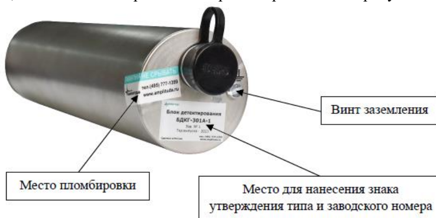
Рисунок 2 – Места размещения знака утверждения типа, заводского номера и пломбировки БДКГ-301А
