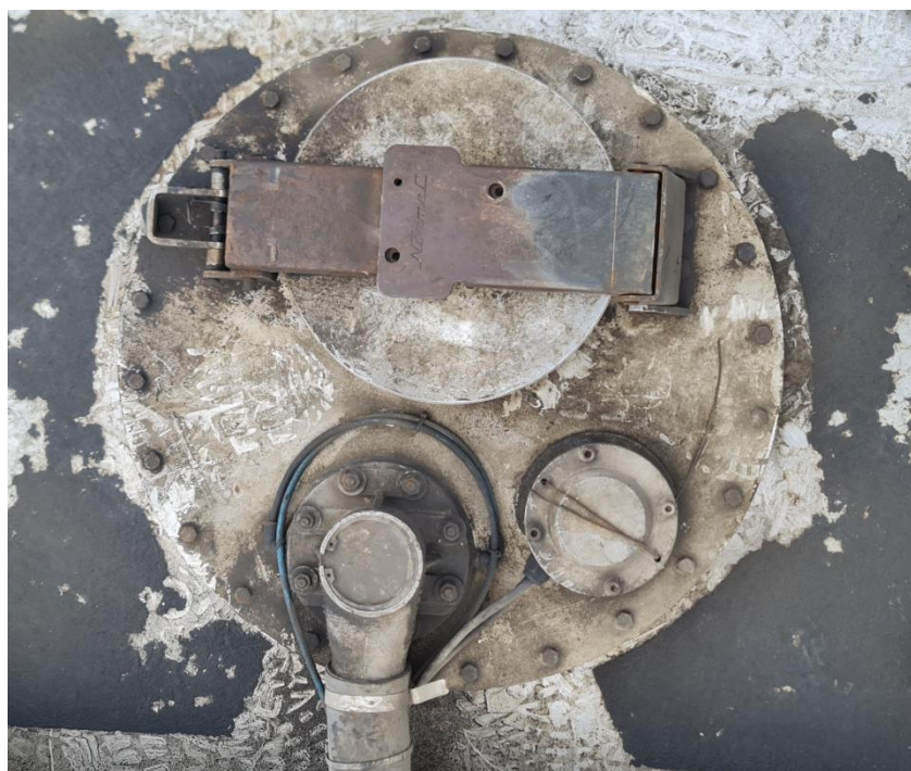
Рисунок 2 – Общий вид горловины автоцистерн 9534S1 ADR FL
