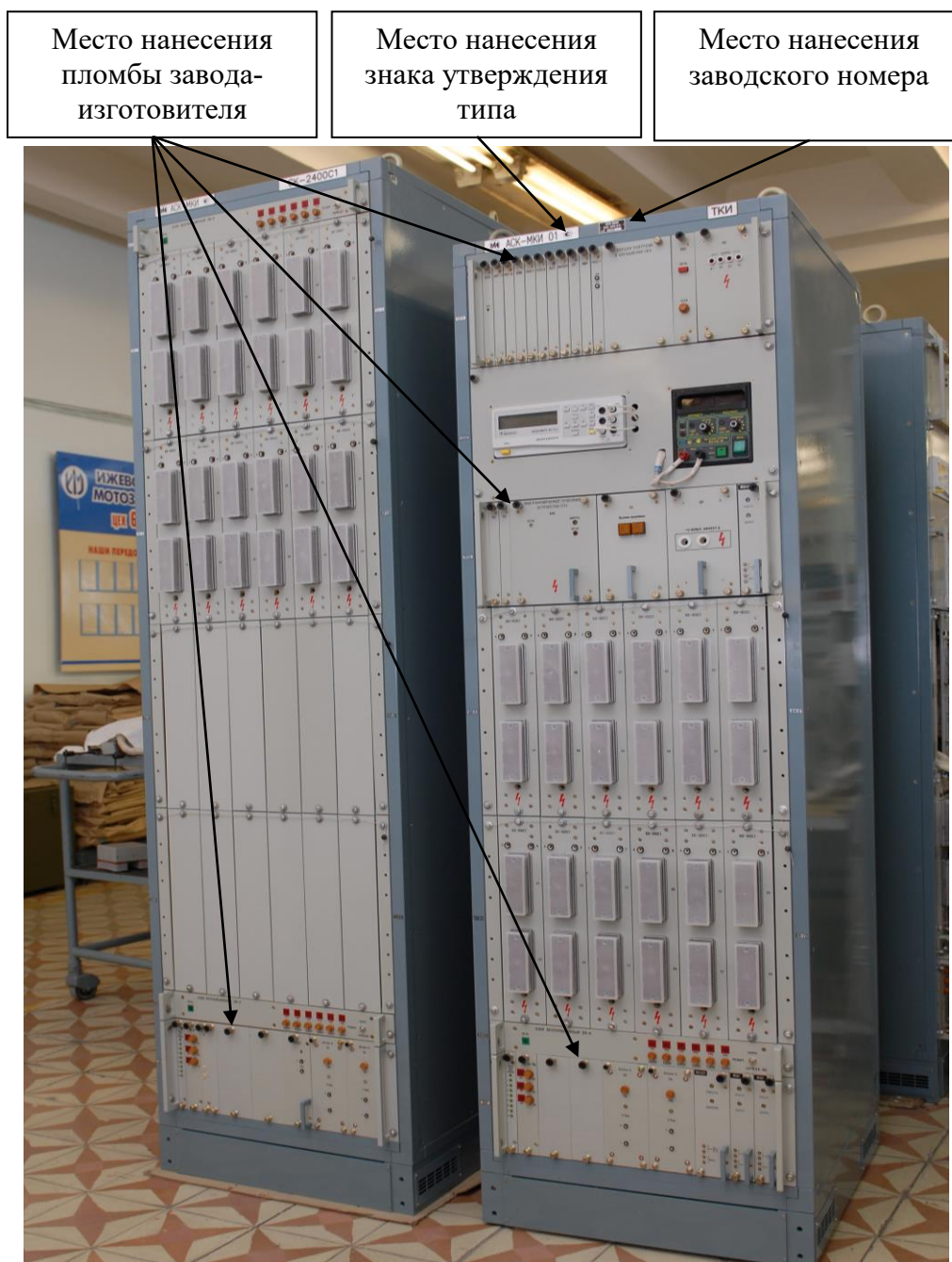
Рисунок 1 – Общий вид систем с указанием места ограничения доступа к местам настройки (регулировки), места нанесения знака утверждения типа, места нанесения заводского номера
