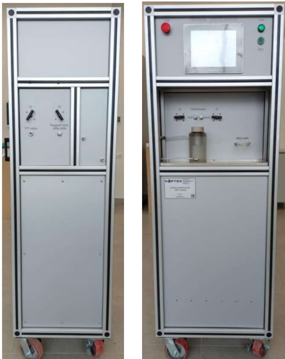
Рисунок 2 – Общий вид газометра с рамой из алюминиевого профиля с вентилями на задней панели ниши, ловушкой для улавливания капель жидкости.
