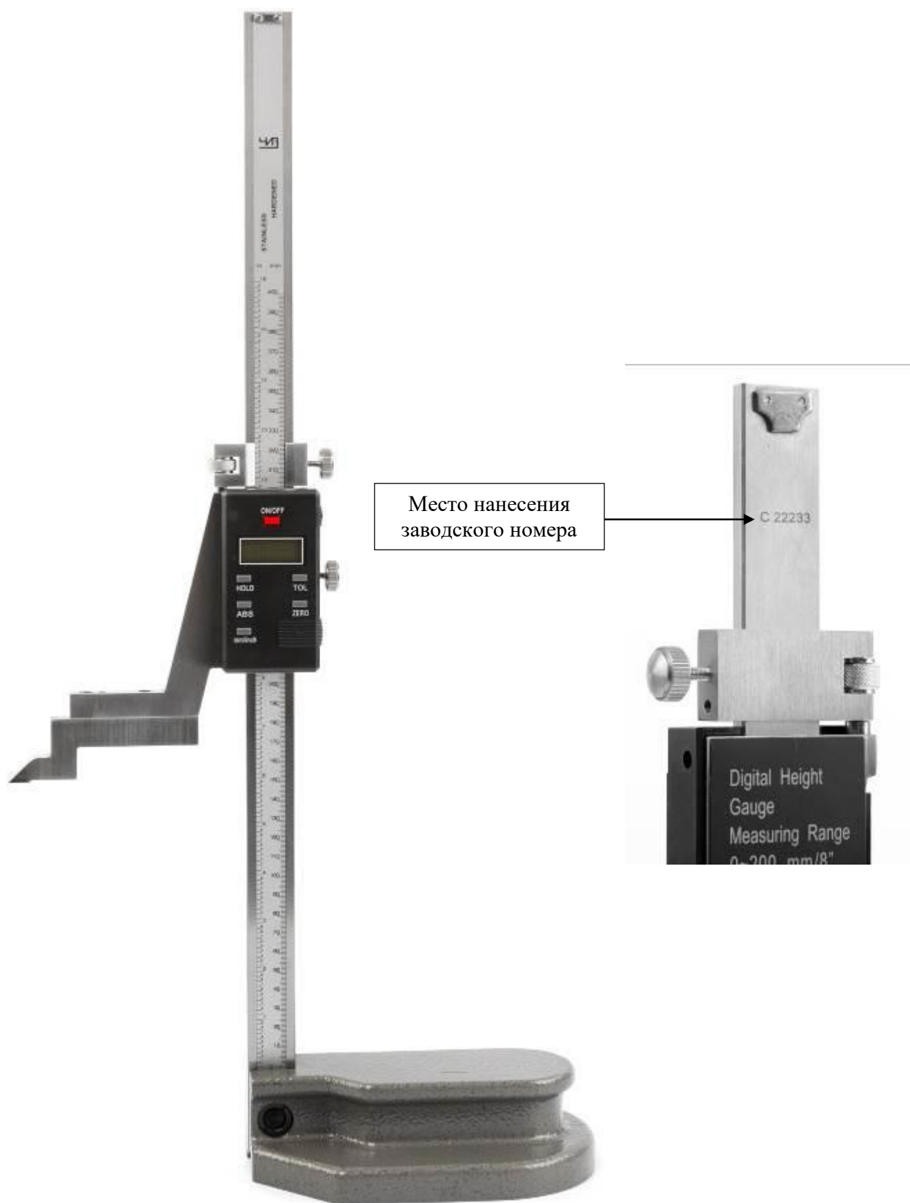
Рисунок 7 – Общий вид штангенрейсмасов модификации ШРЦ и место нанесения заводского номера
