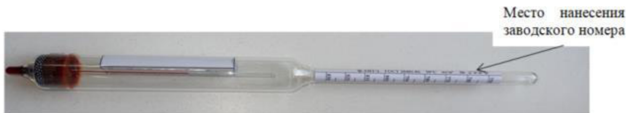
Рисунок 2 – Общий вид ареометров стеклянных для нефти модификации АНТ-1
