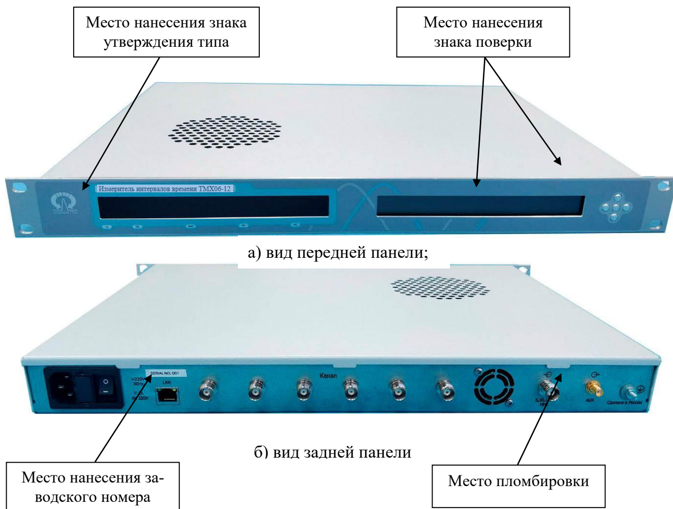
Рисунок 2 – Общий вид ТМХ06-12 с указанием мест пломбировки, мест нанесения знака утверждения типа, знака поверки, заводского номера
