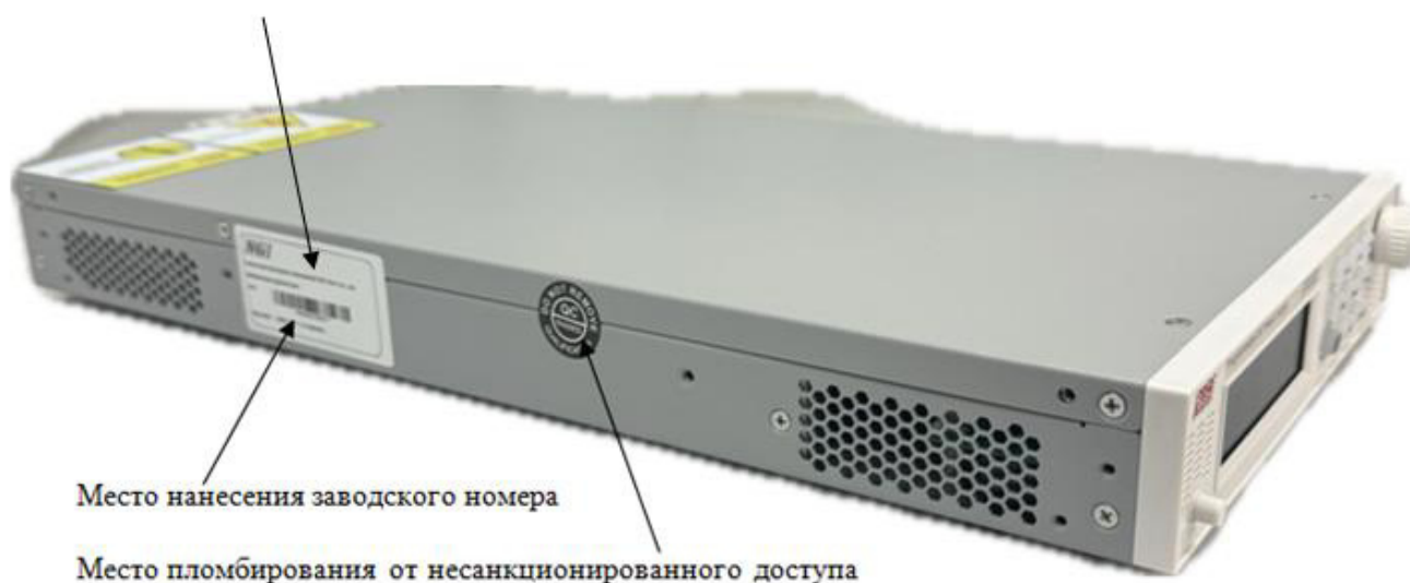
Рисунок 2 - Место пломбирования от несанкционированного доступа, место нанесения заводского номера и знака утверждения типа источников питания постоянного тока N36100
