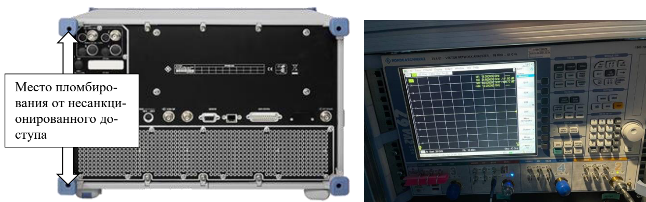
Рисунок 5 – Задняя панель ВАЦ с указанием мест пломбировки от несанкционированного доступа (слева), общий вид ВАЦ (справа)
