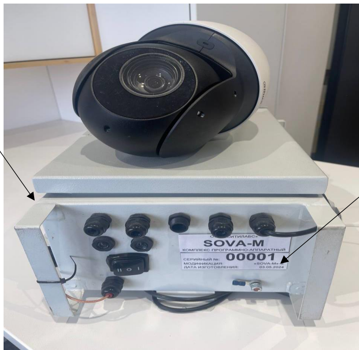
Рисунок 1 – Общий вид комплексов модификации «SOVA-M»-S с обозначением места нанесения знака утверждения типа, серийного номера и места пломбировки от несанкционированного доступа
