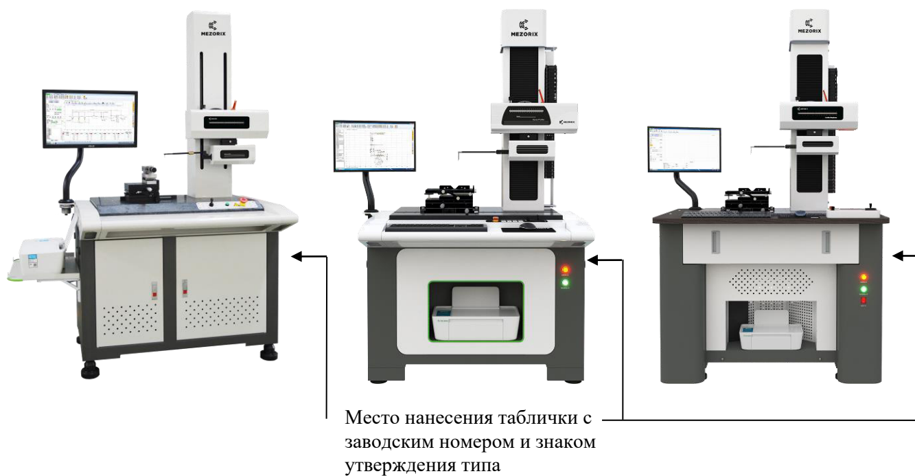
Рисунок 2 – Общий вид приборов для измерений параметров контура и шероховатости поверхности MEZORIX CONTURIX модификаций: а) MEZORIX CONTURIX SP1; б) MEZORIX CONTURIX SP2; в) MEZORIX CONTURIX SP3
