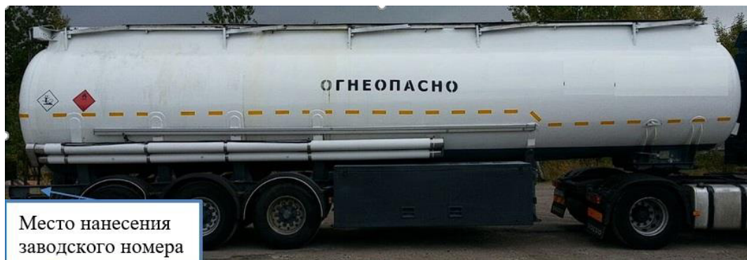
Рисунок 1 – Общий вид полуприцепа-цистерны LAG 03-34-ТР с указанием места нанесения заводского номера
