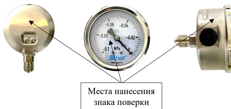
Рисунок 5 – Места нанесения на корпус манометров знака поверки
