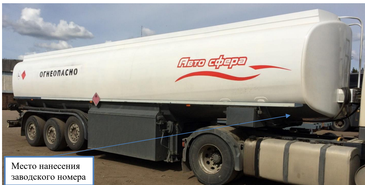
Рисунок 1 – Общий вид полуприцепа-цистерны SCHWARZMULLER зав.№ VAVSAB335XH142558 с указанием места нанесения заводского номера
