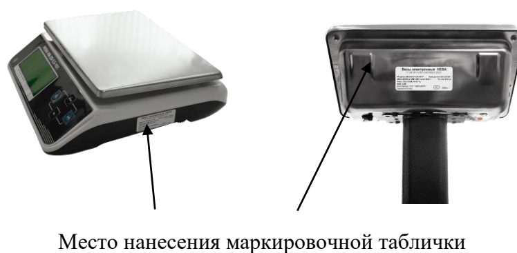
Рисунок 5 — Схема пломбирования весов от несанкционированного доступа и обозначение мест нанесения знака поверки
