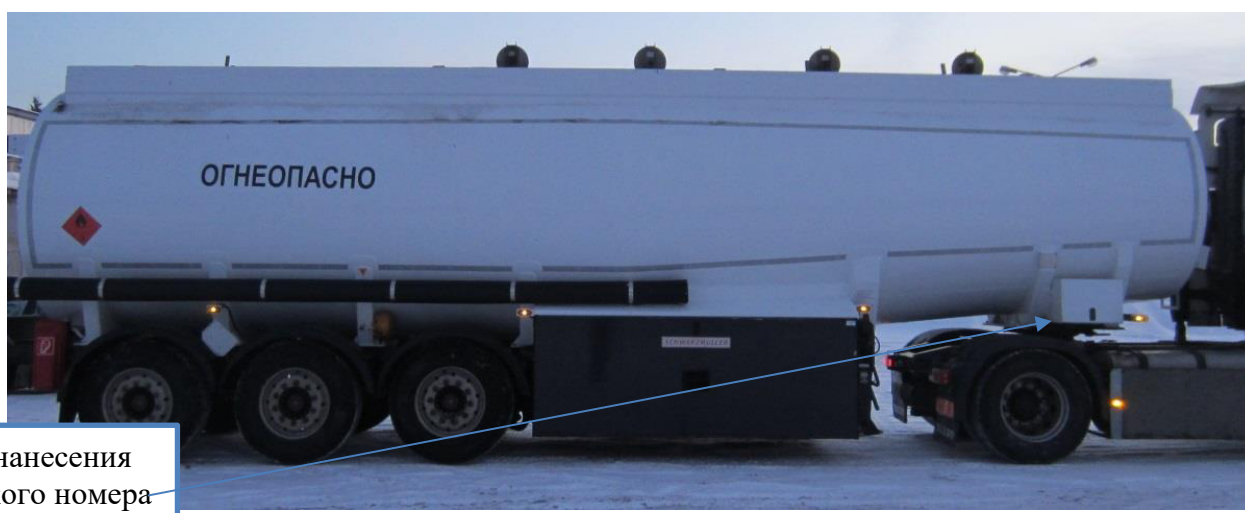
Рисунок 2 – Общий вид полуприцепа-цистерны SCHWARZMULLER зав.№ VAVSAB3388H276426 с указанием места нанесения заводского номера
