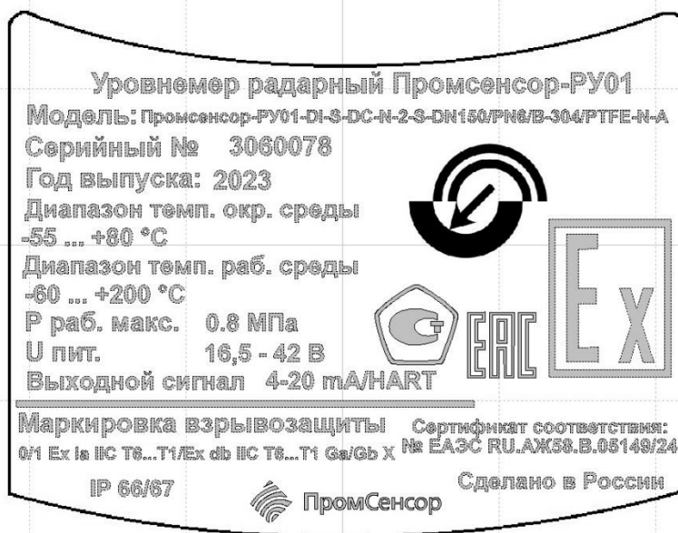
Рисунок 2 - Пример обозначений на информационных табличках уровнемеров (однокамерный корпус)
