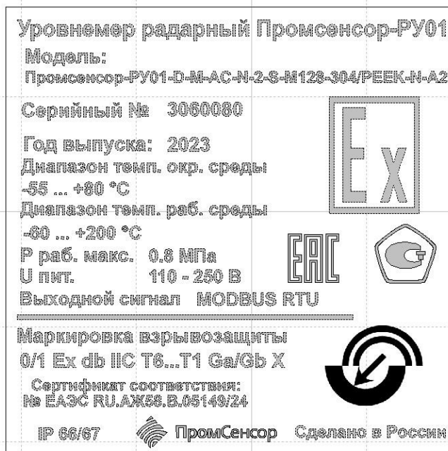
Рисунок 2 - Пример обозначений на информационных табличках уровнемеров (однокамерный корпус)
