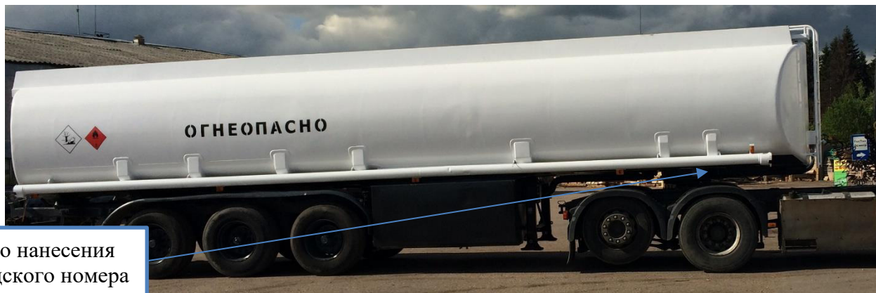
Рисунок 1 – Общий вид полуприцепа-цистерны ROHR-TAL-A-K с указанием места нанесения заводского номера
