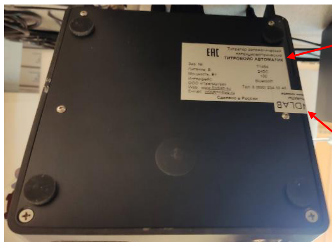
Рисунок 6 - Блок управления титратора с местами нанесения шильдика с заводским номером титратора и пломбы, вид снизу
