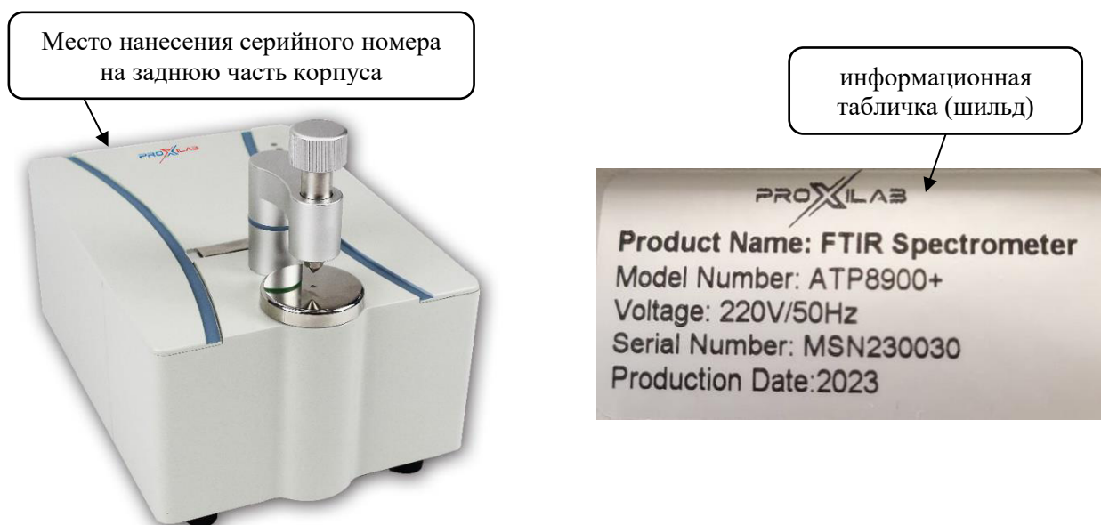
Рисунок 1 – Общий вид спектрометра, обозначение места нанесения серийного номера на спектрометр, информационная табличка (шильд) спектрометра
