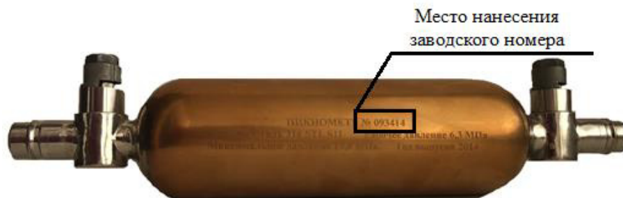
Рисунок 1 – Общий вид пикнометра с указанием места нанесения заводского номера
