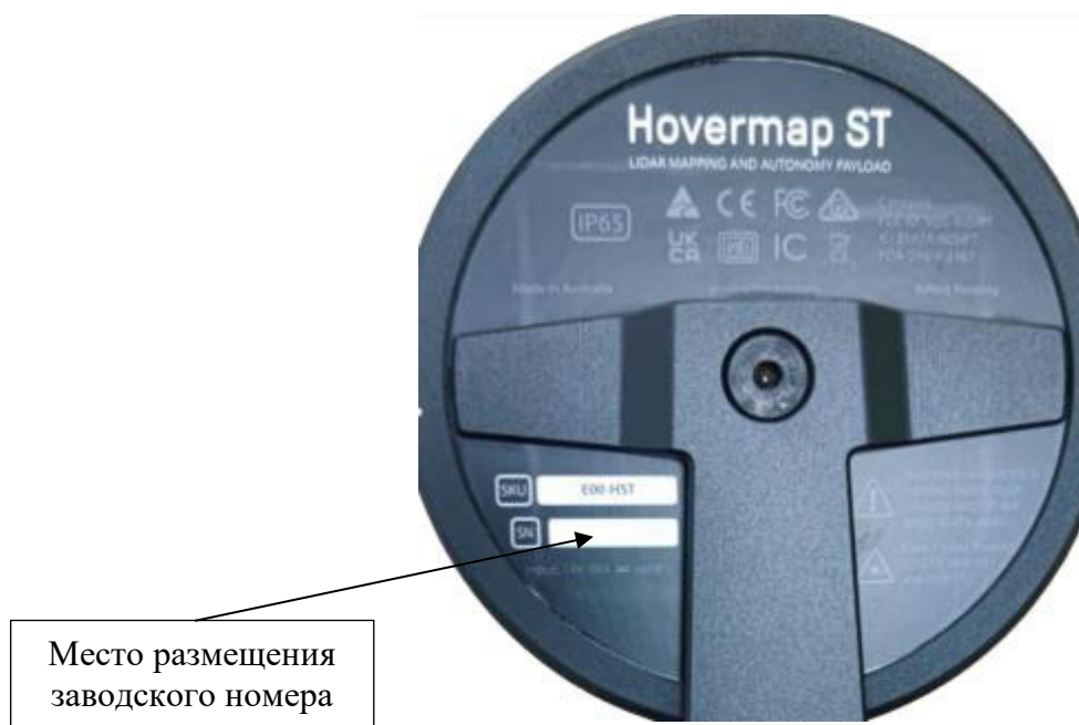
Рис. 2 – Место размещения заводского номера
