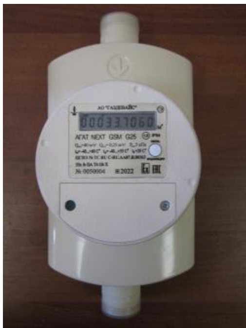
Рисунок 1 – Общий вид счетчиков газа ультразвуковых АГАТ NEXT в исполнении "Круг"
