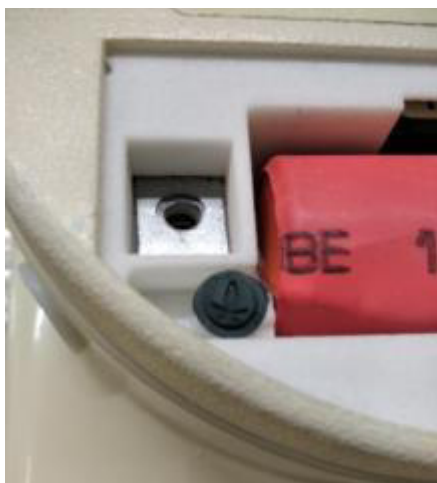
Рисунок 5 – Место пломбирования батарейного отсека измерительного модуля
