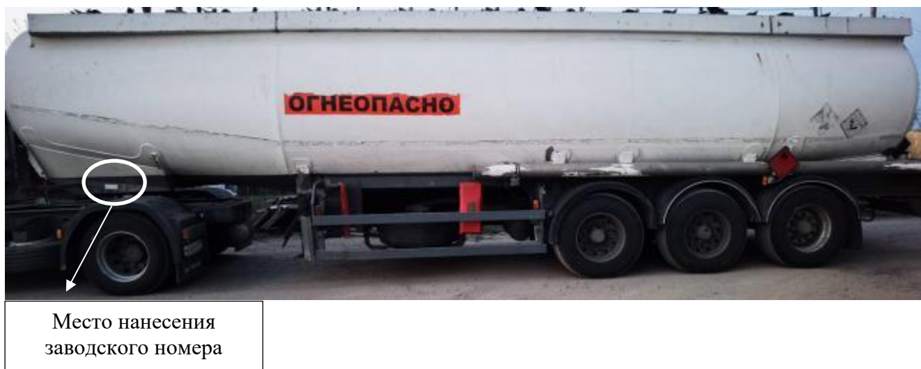
Рисунок 1 – Общий вид полуприцепа-цистерны GENERAL TRAILERS и место нанесения заводского номера
