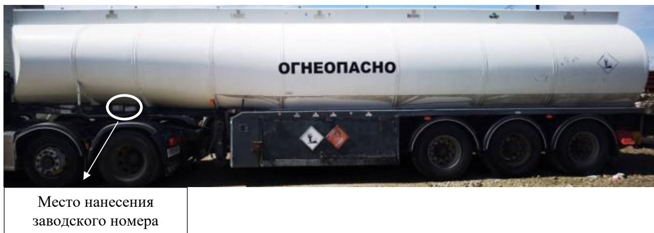
Рисунок 1 – Общий вид полуприцепов-цистерн НЕIL PT44/3 и место нанесения заводского номера
