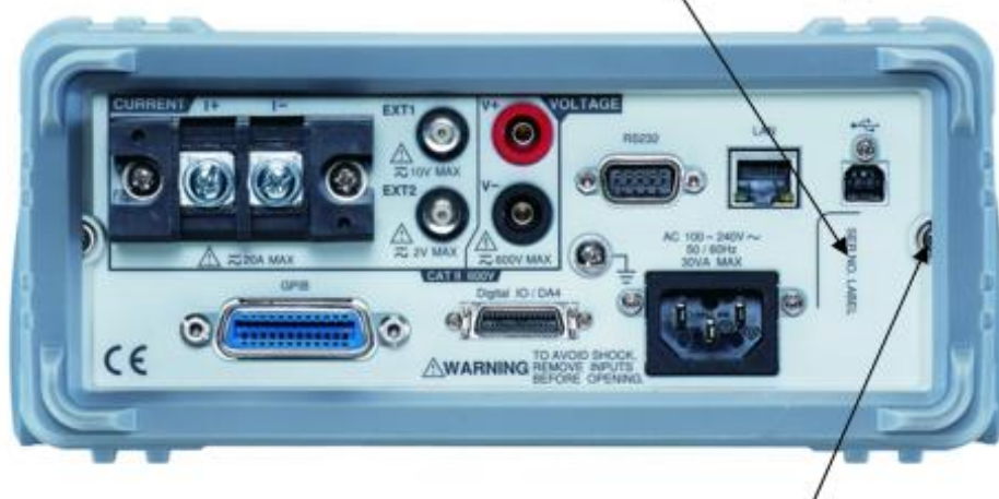
Рисунок 4- Место нанесения заводского номера измерителей электрической мощности GPM-78310 и схема пломбирования от несанкционированного доступа
