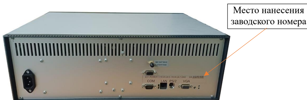
Рисунок 2 – Вид задней панели осциллографа TMR8250 с указанием места нанесения
