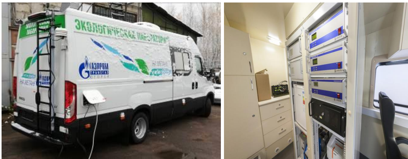
Рисунок 2 – Общий вид станции контроля загрязнения атмосферного воздуха автоматической «Чистый воздух PRO» (мобильное исполнение, вид снаружи и внутри станции)
