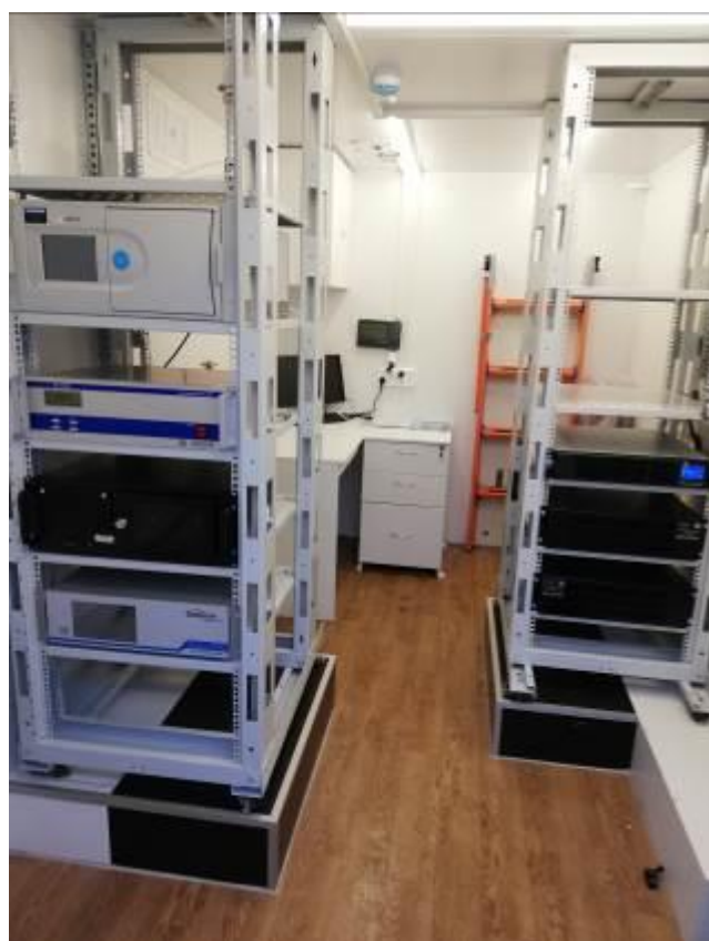
Рисунок 1 – Примеры общего вида станций контроля загрязнения атмосферного воздуха автоматических «Чистый воздух PRO» (стационарное исполнение, вид снаружи и внутри станции)
