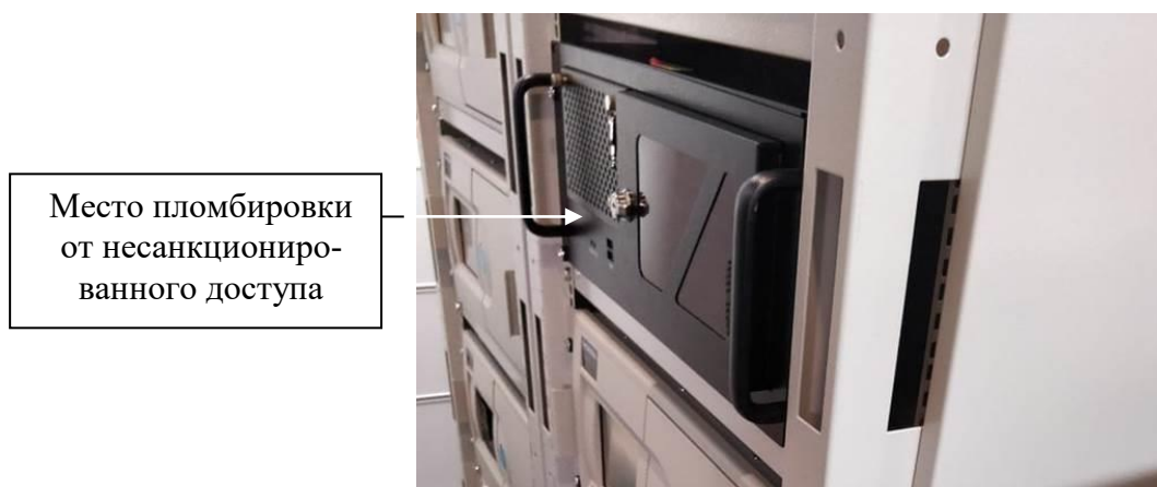
Рисунок 3 – Схема пломбировки от несанкционированного доступа (системный блок компьютера)
