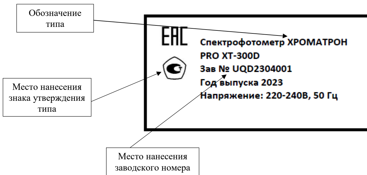
Рисунок 5 – Вид информационной таблички (шильда) спектрофотометров и мест нанесения обозначения типа, знака утверждения типа и заводского номера
