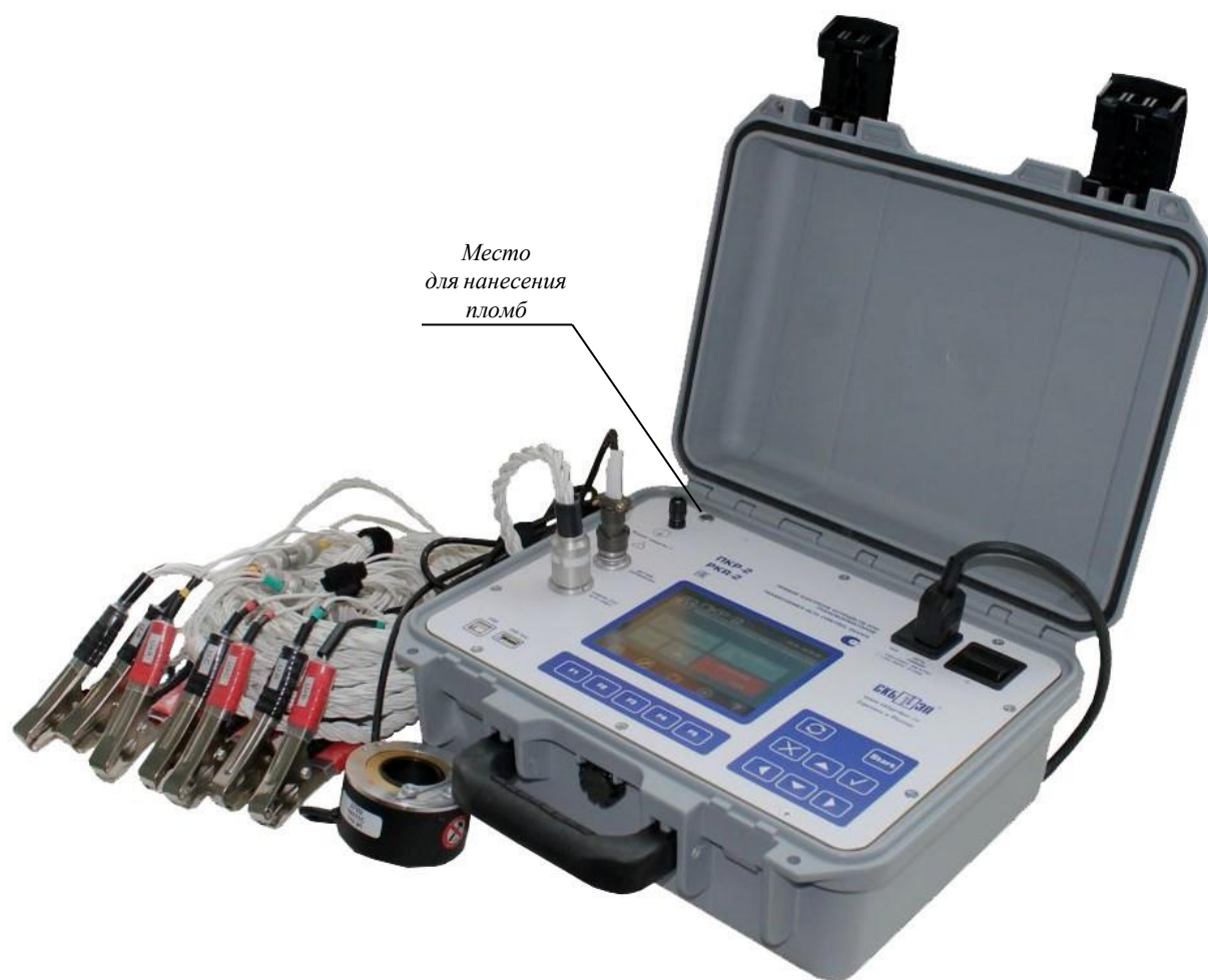
Рисунок 2 – Измерительный блок, датчик угловых перемещений, комплект монтажных приспособлений и комплект кабелей
