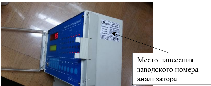
Рисунок 3 - Общий вид блока контроллера анализатора (модификации ДКНБ.421451. 010) указанием места нанесения заводского номера.
