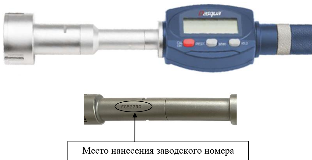
Рисунок 3 – Общий вид нутромеров модели 4711 с указанием места нанесения заводского номера
