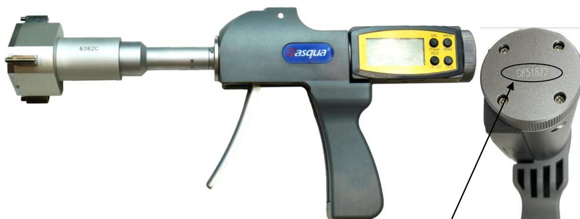
Рисунок 6 – Общий вид нутромеров модели 4511 с указанием места нанесения заводского номера
