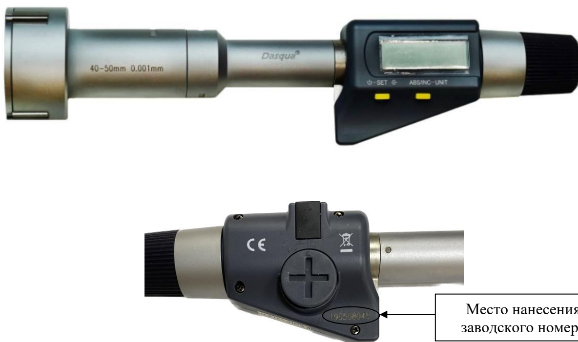
Рисунок 5 – Общий вид нутромеров модели 4511 с указанием места нанесения заводского номера
