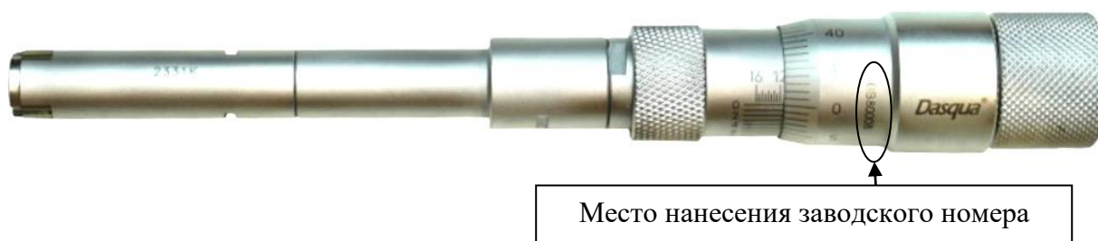
Рисунок 2 – Общий вид нутромеров модели 4411 с указанием места нанесения заводского номера
